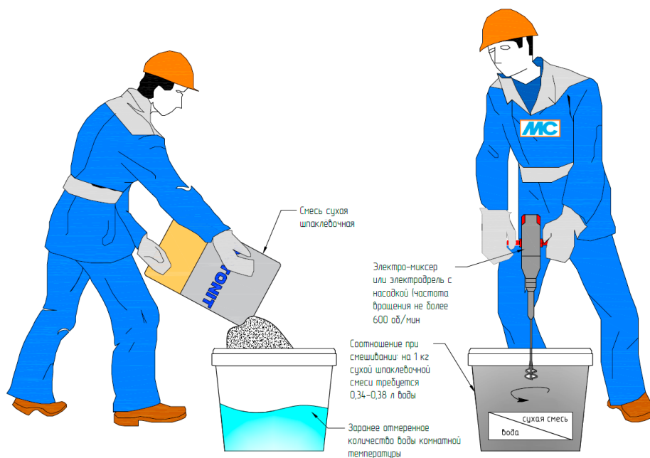
Рис. 20. Организация работ по затворению сухой шпаклевочной смеси
